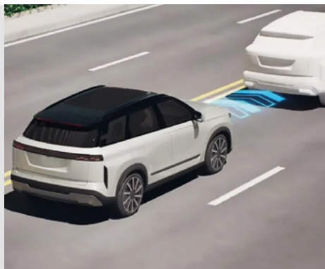
System ostrzegania przed kolizją z przodu (FCW)
