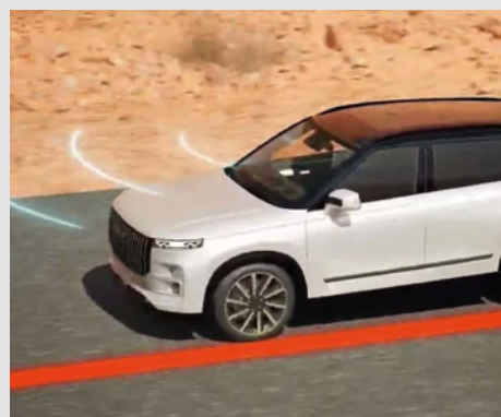
System zapobiegający niekontrolowanej zmianie pasa ruchu (LDP)
