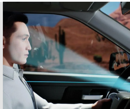
System monitorowania uwagi kierowcy (DMS)
