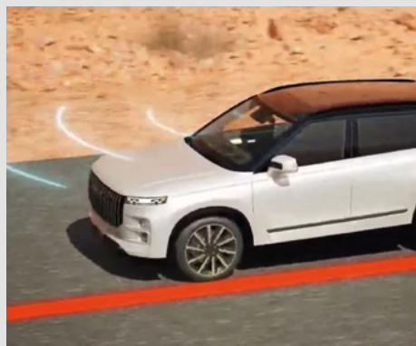
System zapobiegający niekontrolowanej zmianie pasa ruchu (LDP)
