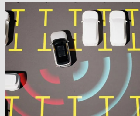
System ostrzegania przed kolizją podczas cofania (RCW)
